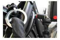
Nach dem Öffnen der Schlösser wird der Akku zwischen Gepäckträger und Hinterrad in die Führung geschoben. Das Einrasten hört man durch ein Klicken. Dann wird der Fahrradcomputer in der Mitte des Lenkers in die Halterung geschoben. Der Akku kann nun eingeschaltet werden. Der Akkustand ist an den leuchtenden grünen Punkten abzulesen.
